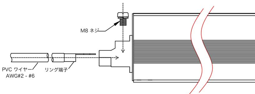
△ 注意 インバータの入力側とバッテリー間に、ブレーカーやリレーなどの開閉器は接続しないで下さい。インバータの入力にサージ電流が流れ壊れる恐れがあります。その際は、保証外となりますのでご了承下さい。
