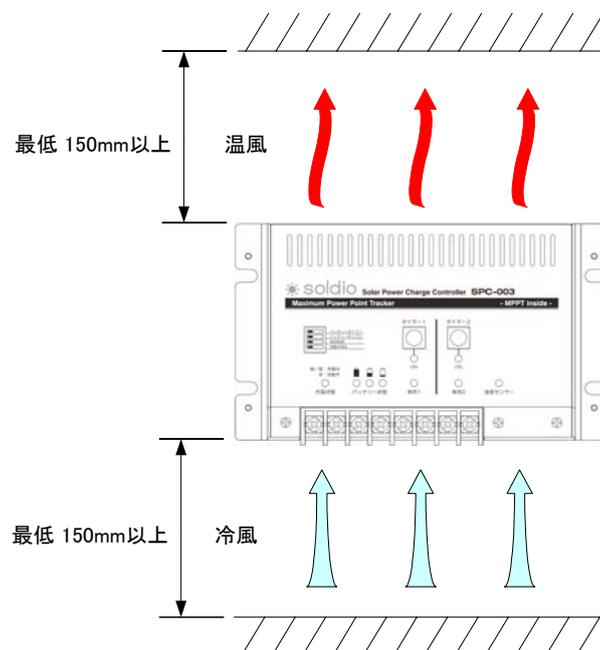
図 3. 取付けと冷却
