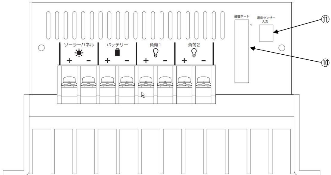
図 2. 充放電コントローラーの外観(前面)
