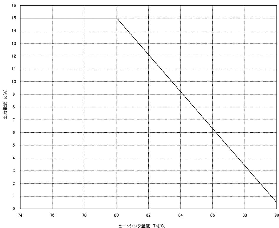
図10. 過温度保護（ヒートシンク温度と出力電流）
